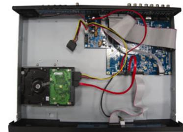
Paso 4: Conecte los conectores de alimentación y bus de datos a la unidad HDD.
