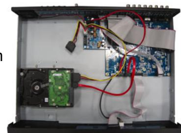
Fase 4: Collegare il connettore di alimentazione e il connettore bus dati al disco rigido.
