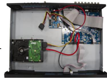
Schritt 4: Verbinden Sie den Netz- und Datenbusanschluss an der Festplatte.
