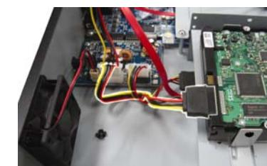
ブラケットのねじ穴を HDD のねじ穴と揃えください。HDD の PCB 側が上を向いているよう確認してください。HDD をブラケットに止め付けます。
