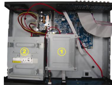
Fissare il disco rigido alla staffa, e collegare il connettore di alimentazione e il connettore bus dati al disco rigido. Quindi, riposizionare la staffa sul DVR.
