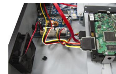
Haga coincidir los orificios del soporte con los orificios de la unidad HDD. Asegúrese de que la cara de la unidad HDD que muestra una placa de circuito impreso (PCB) quede orientada hacia arriba. A continuación, fije la unidad HDD al soporte.
