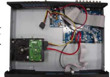
ステップ 4: HDD に電源コネクタおよびデータバスコネクタを接続します。
