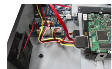
Richten Sie die Schraubenlöcher der Halterung an den Schraubenlöchern der Festplatte aus. Achten Sie darauf, dass die PCB-Seite der Festplatte nach oben zeigt. Befestigen Sie dann die Festplatte an der Halterung.
